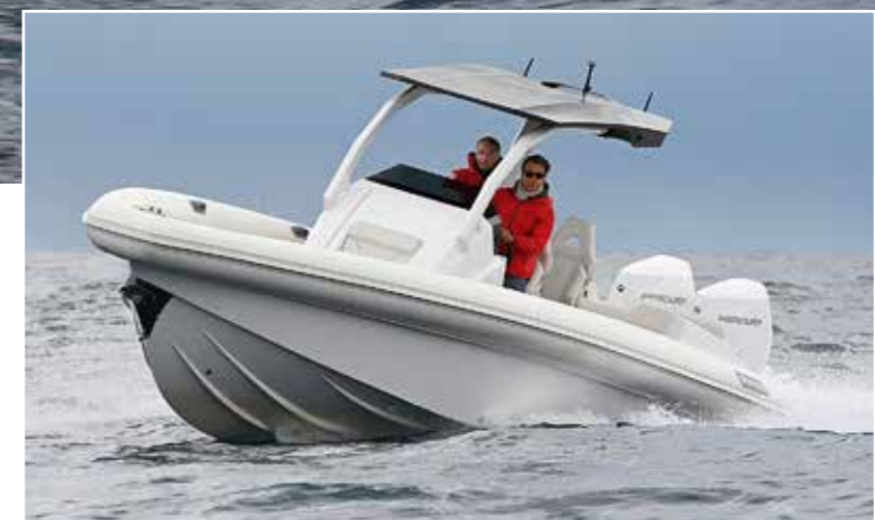
En virage, les flotteurs ne touchent pas l'eau, exception faite de la toute dernière partie, à l'arrière. Mais la carène s'appuie sur son gros redan, apportant une gîte modérée dans les courbes serrées.
