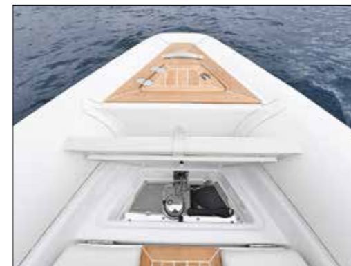
L'ancre traversante et le guindeau sont accessibles depuis une baille située à l'avant.
